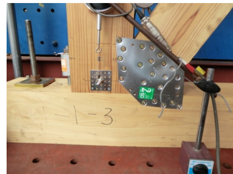
写真3 現在の筋かい金物の一例
